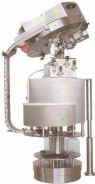
Укупорочная головка для закупоривания алю-пробок
