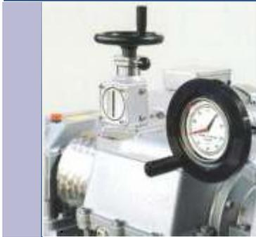
Устройство для ручного регулирования хода поршня
