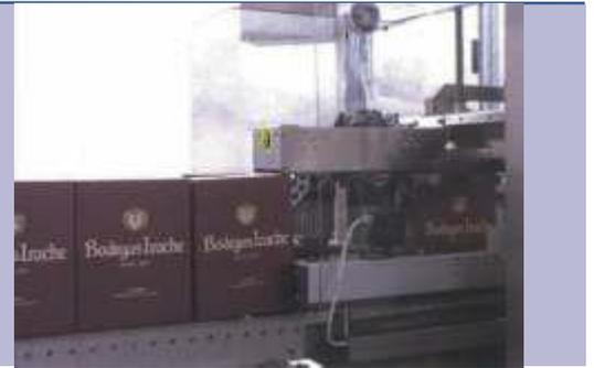
**Единица для заклеивания верхней и нижней части коробки клеейкой-лентой**
