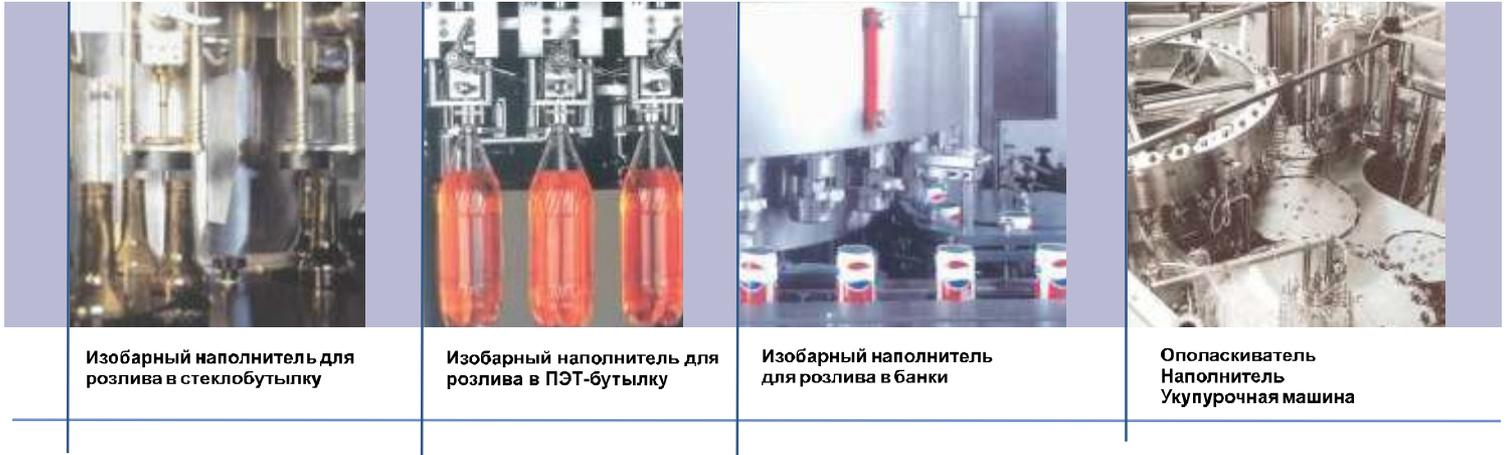
**Ополаскиватель** ополаскивает и стерилизует бутылки от каждой нечистоты перед розливом. Ополаскивание может происходить в одном и/ли двух этапов, после которых происходит стекание. Присоединением добавочного, соответствующего устройства для рециркуляции воды, возможно собирать и рециркулировать жидкость ополаскивания
